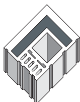
BLOCCO PX38 ANGOLO (SxHxL) 380x200x500 mm
